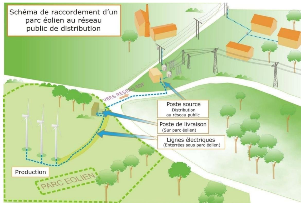
Figure 5 : Raccordement électrique au réseau de distribution
